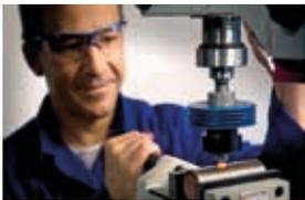
Beim Thermbohren wird durch Reibungshitze aus dem vorhandenen Material spanlos eine verdrehsichere Buchse geformt und dann ein Gewinde eingebracht.
