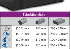
Der Schnittbereich wurde mit Aluminium ermittelt. Er kann beim Einsatz unterschiedlicher Materialien va Umständen kleiner ausfallen (nicht Schnittkapazität).
